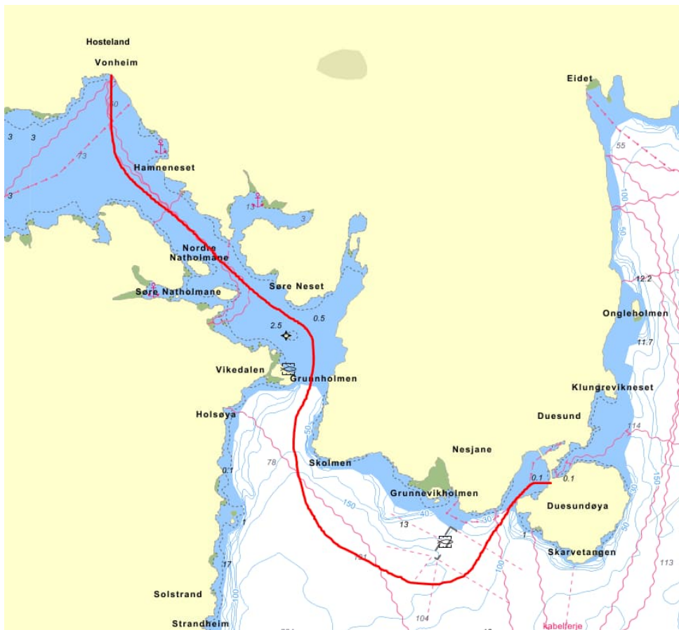
Figur 8: Sjøkart med trase for ny sjøleidning mellom Duesund og Hosteland. (Kjelde: www.gulesider.no)
