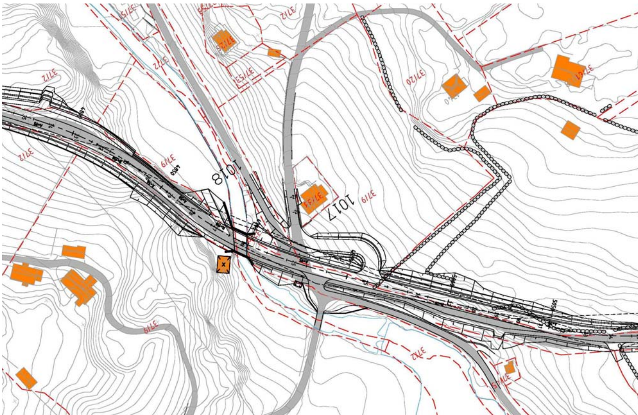
Figur 26: Løysing med samla avkjøring til Kvingebakken, og eit kryss mot Kvingedalen. Løysinga gir ikkje rom for etablering av busstopp ved krysset og medfører større inngrep på landbruksjord.
