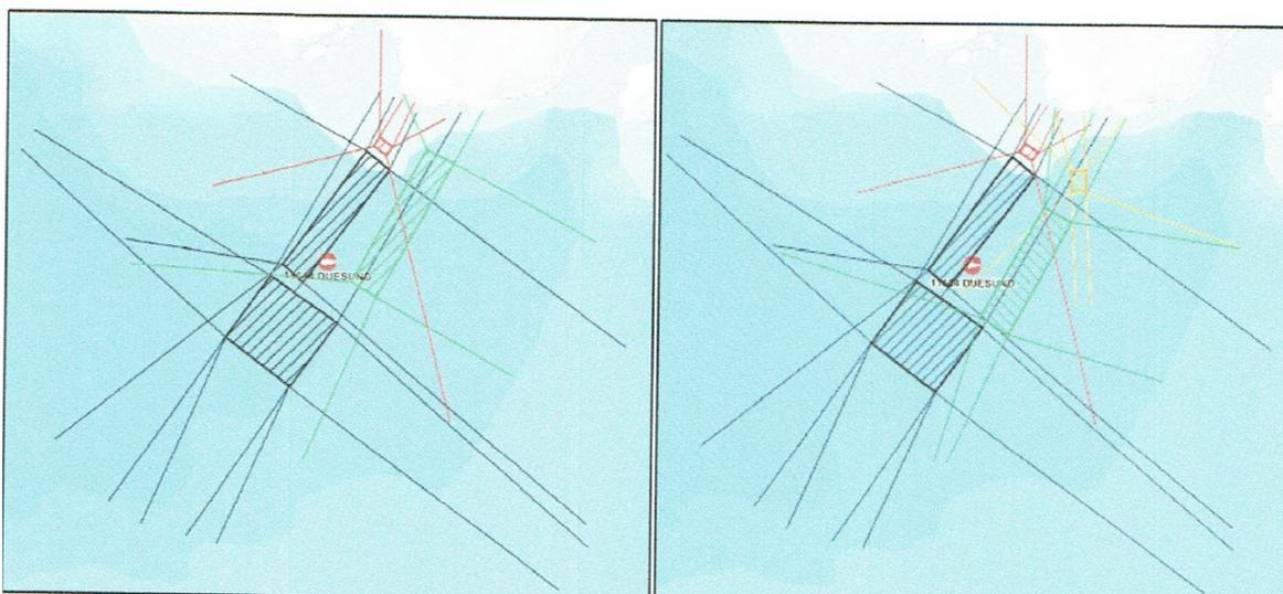
**Figur** syner dagens godkjente anlegg til venstre og omsøkt anlegg til høyre. Svart skravert er område for fiskeoppdrett, rødt skravert er eksisterande fôrflåte medan figur med orange farge er ny fôrflåte.
