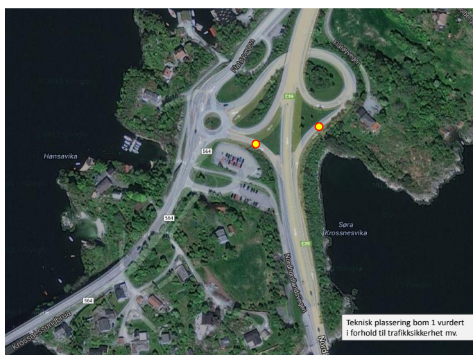
FIGUR 12. TEKNISK PLASSERING AV AUTOPASS-SNITT, BOMSTASJON 1, HOVUDKRYSS FLATØY.
