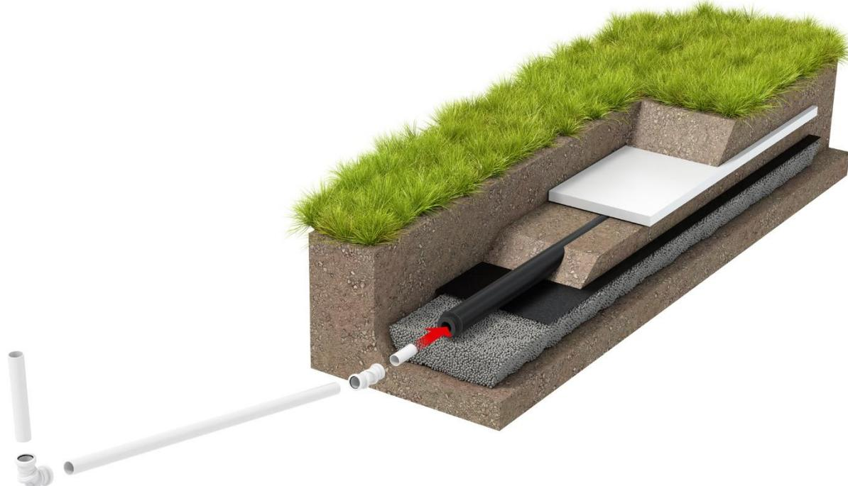
Urinen dreneres ut i midten av et 30cm lag med Lecakuler/grov pukk med lite finstoff. Over drenslaget legges fiberduk og et ca 30 cm lag jord for å hindre luktdannelse og frost. Pakken består av et perforert 110mm rør, lengde 2 meter, en fiberduk på 2x0,5m. I tillegg trenger du et 50mm rør/bend frem til toalettet og 50 liter filtralite rensemedium. Om ønskelig kan grøfta isoleres med vintermatter eller lignende.
