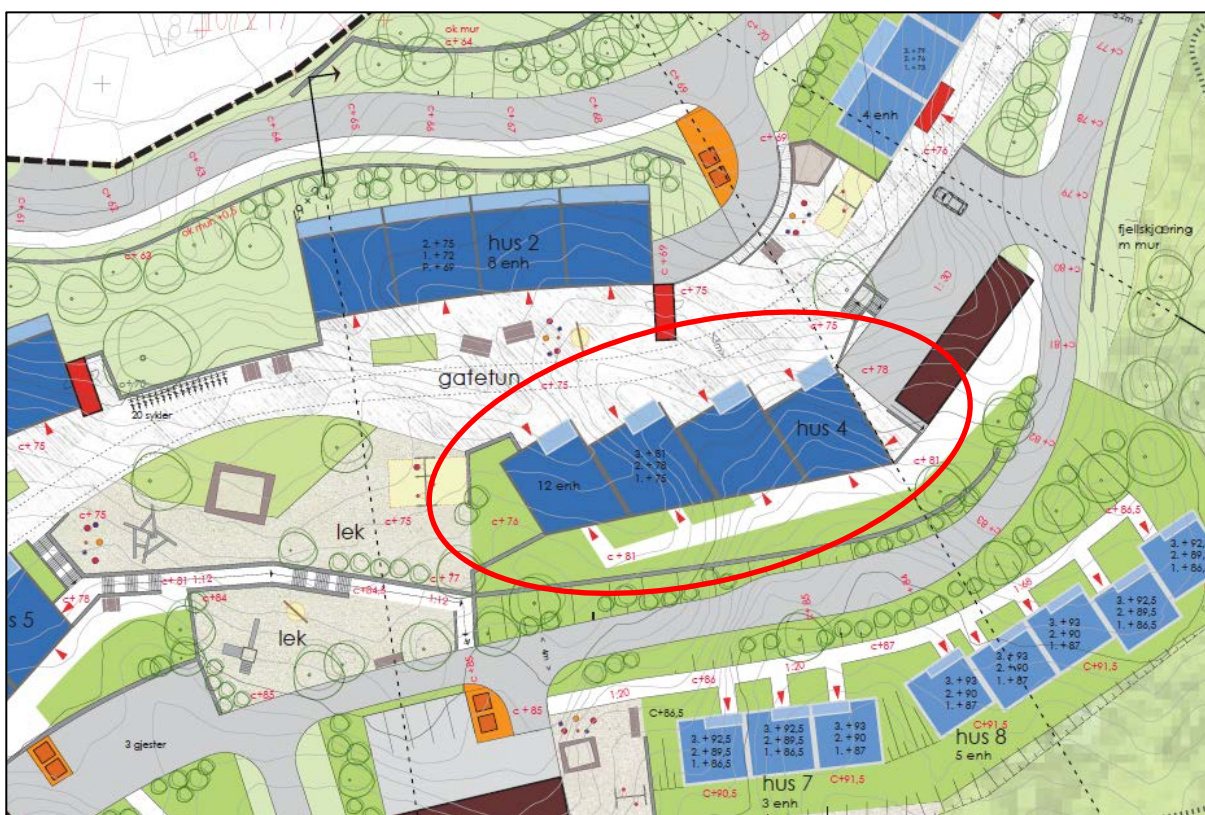
Figur 20. Del av illustrasjonsplan som viser område BBB4 med løysing for tilkomst til bustadane, gatetun, gangveggar og trappeløysingar (ABO Plan & Arkitektur AS).
