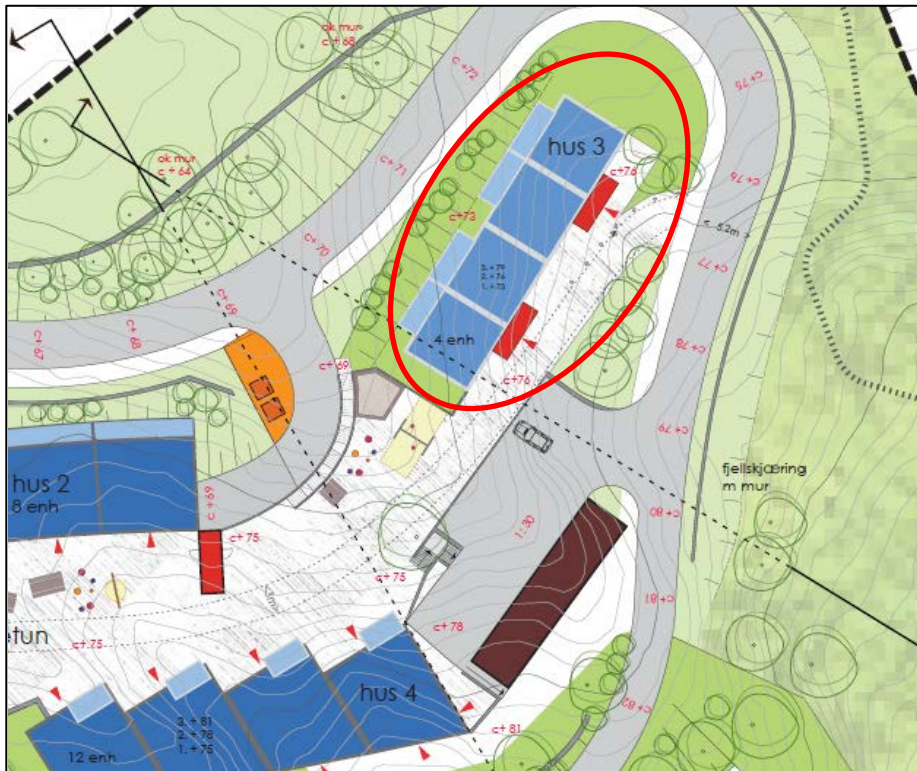
Figur 22. Utsnitt av illustrasjonsplan som viser område BKS2 med løysing for tilkomst til bustadane, nærleikeplass, gatetun, gangvegar, parkering og trappeløysingar (ABO Plan & Arkitektur AS).
