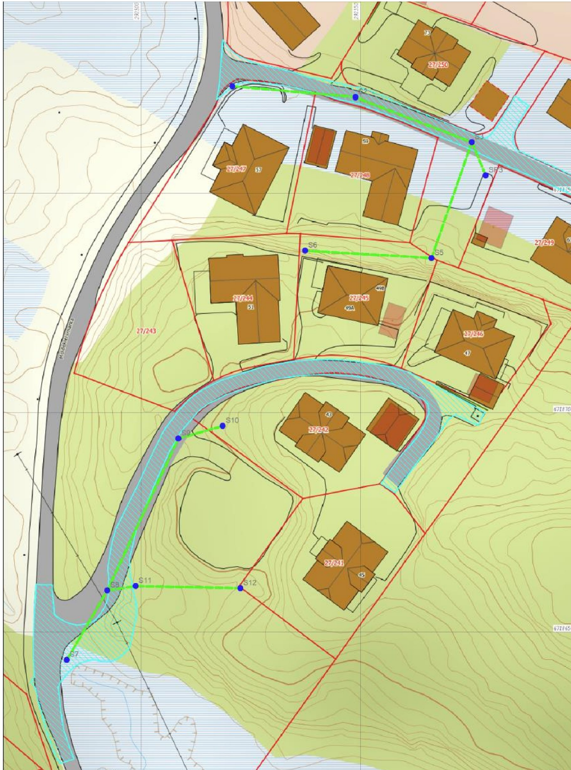
Oversiktskart med innmålt vei og VA-anlegg
