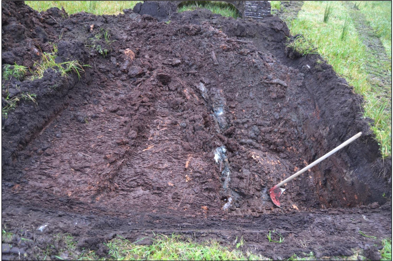
Figur 29. Oversyn undergrunnsforhold område 3 (sjakt 13 B) myr over berg.
