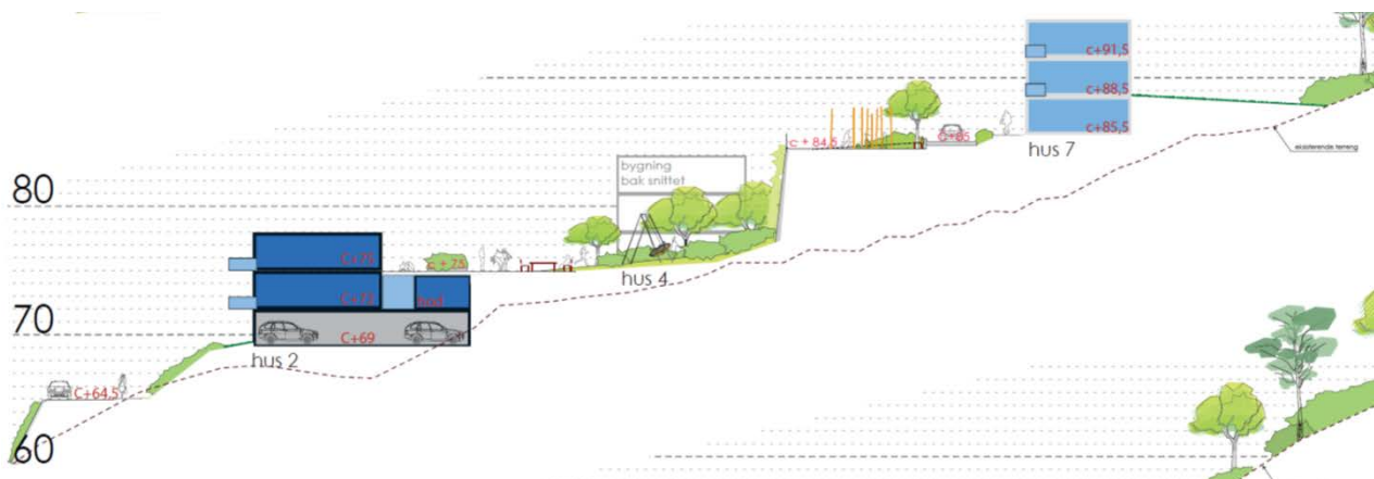
Figur 34. Snitt 2 som viser korleis bustadane er tenkt plassert i terrenget med leik- og uteopphaldsareal mellom (ABO Plan & Arkitektur AS).
