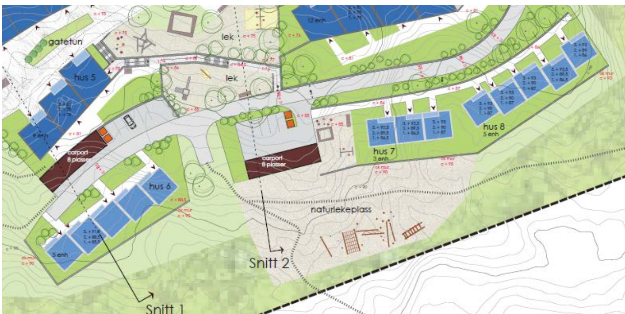
Figur 23. Illustrasjonsplan som viser område BKS5 og BKS6 med løysing for tilkomst til bustadane, gangvegar, leikeområde, parkering (ABO Plan & Arkitektur AS).
