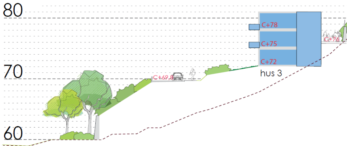
Figur 32. Del av snitt gjennom området med høgaste vegskjeringar vist i snitt 3 i illustrasjonsplanen (ABO Plan & Arkitektur AS).
