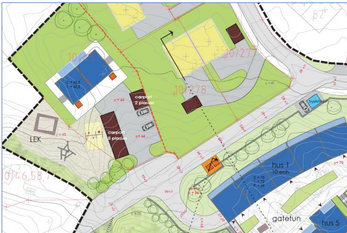
Figur 26. Illustrasjonsplan som viser område BKS7 med løsning for tilkomst til bustadane, leik- og uteopphaldsareal og parkering (ABO Plan & Arkitektur AS).
