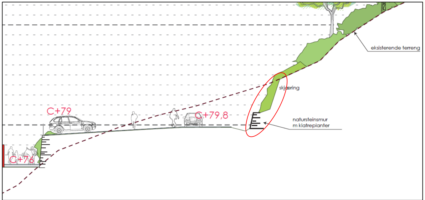
Figur 34. Del av snitt 4 i illustrasjonsplanen gjennom området med høgast vegskjering lengst sør (ABO Plan & Arkitektur AS).
