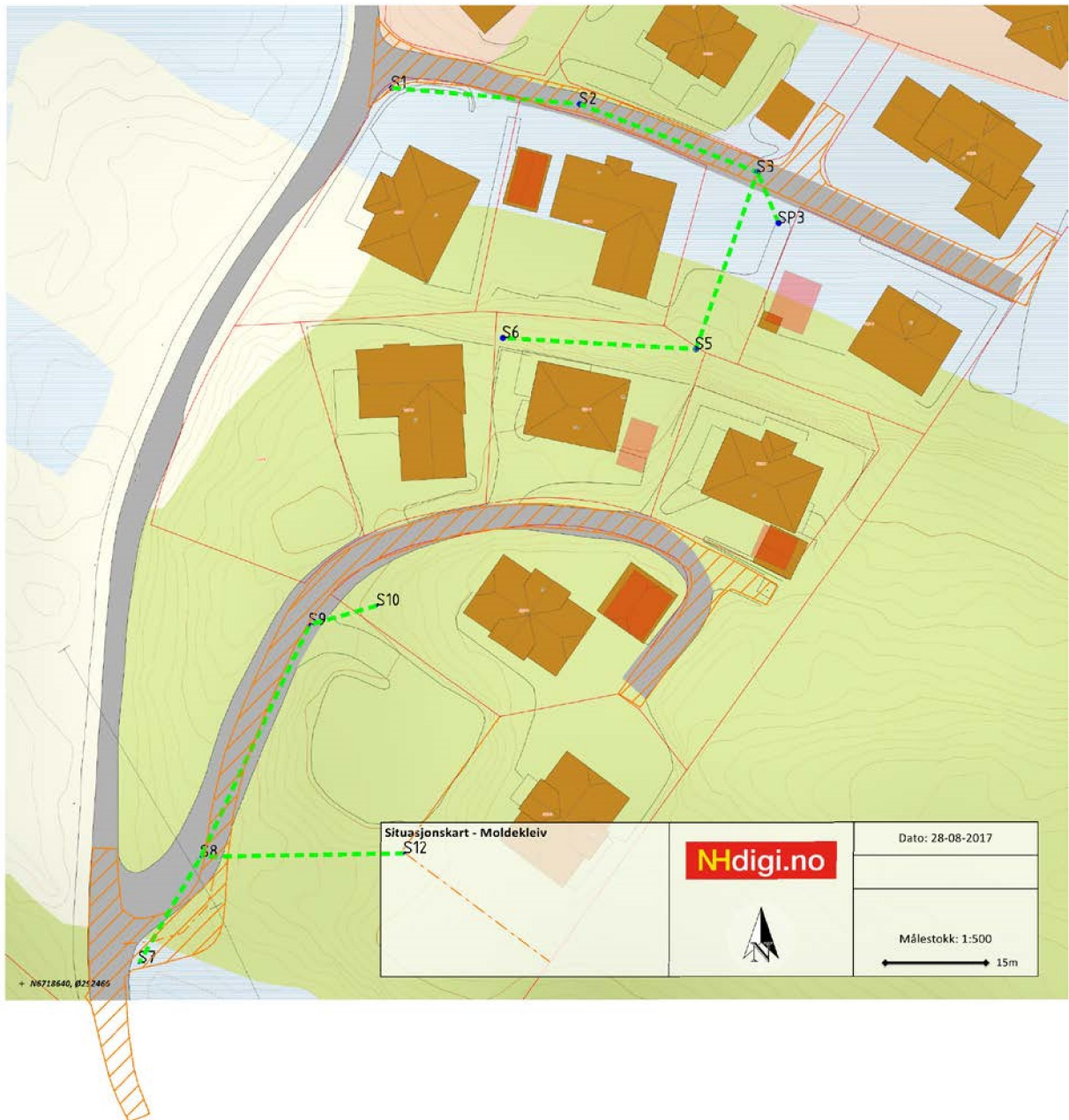
Oversiktskart med innmålt vei og VA-anlegg
