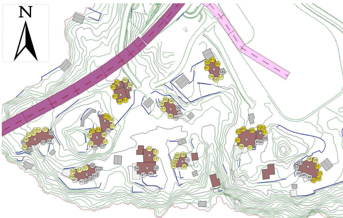
Figur 8. Beregnet støynivå L_{den} [dB] ved fasader til boliger sør i planområdet, for planlagt fremtidig situasjon.
