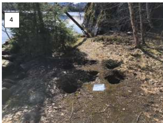
Figur 4-4: Bildet nr. 1 viser PG1 med innhold av stein og sand, og med et toppsjikt av organisk materiale. Bildet nr. 2 viser PG2, prøvepunktet rett nord for verkstedet hvor det var påtreff av en betongplate. Bildet nr. 3 viser de rødbrune løsmassene som ble påtruffet i stikkprøvene i PG5. Bildet nr. 4 viser stikkprøvene tatt ved PG6.
