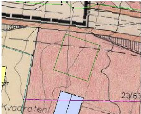
Det er søkt om topp golv på kote ca. + 26,3 og mønehøgde på kote ca. + 33,4. Det er søkt om planeringshøgde på kote + 25,5.
