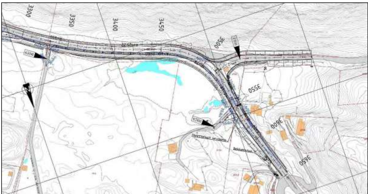
Figur 81; Utbetra kryss i profil 3490.
