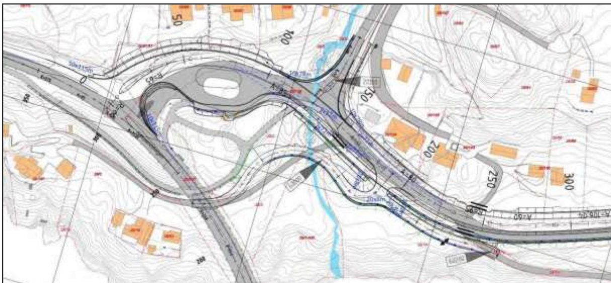
Figur 77; Fossekrysset oppgraderast og avkøyrsla etter Fossekrysset flyttast og sikrast betre sikt.
