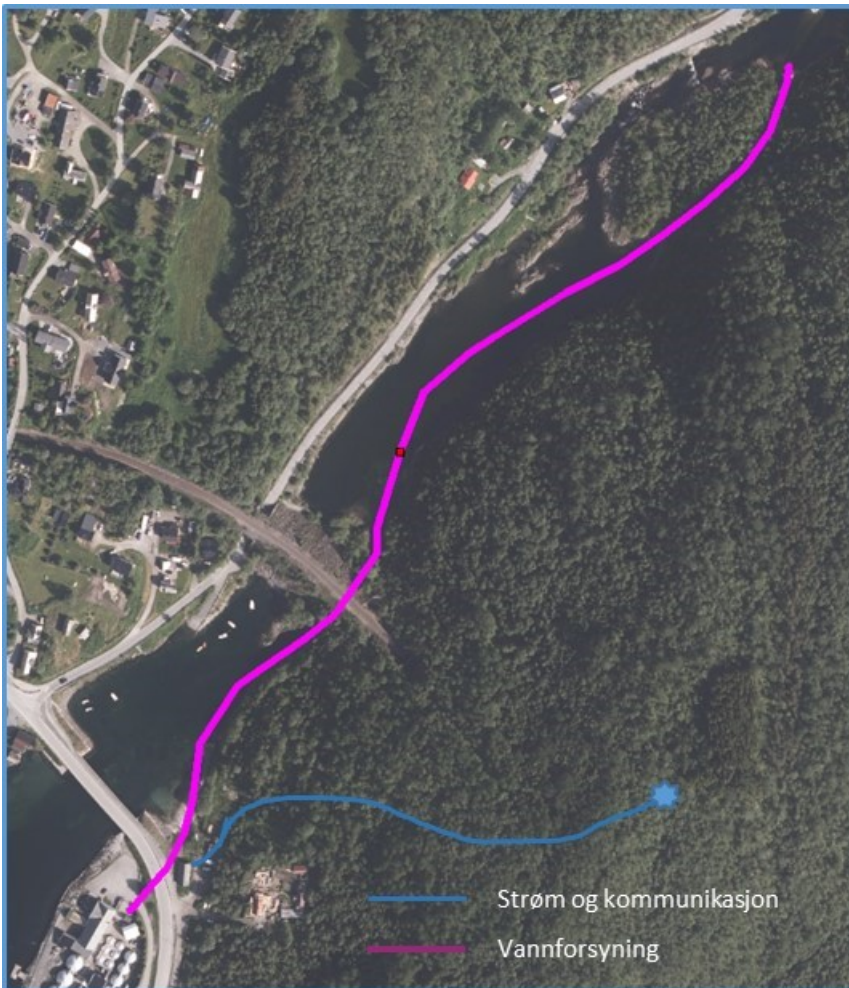
Figur 3.3. Inntaksledning for privat vannforsyning. Nedgravd ledninger for strøm og kommunikasjon til mobiltelefonmast
