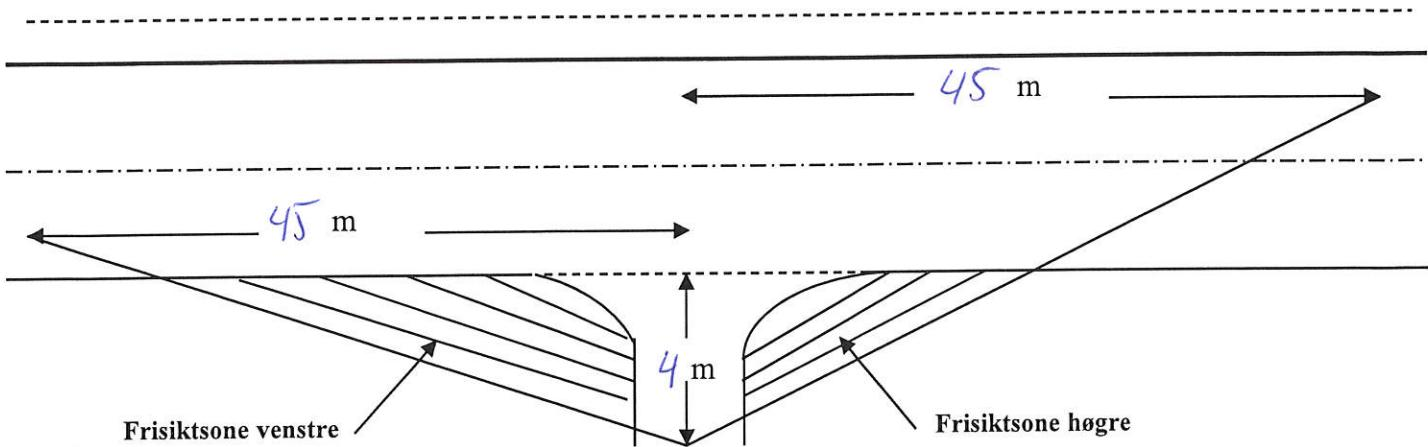
Tilsvarande sikt lengder som vist på tegningen må også gjelde for trafikken som kjem på hovedvegen og skal inn i avkjørsla (sikt bakover og framover langs hovedvegen)
