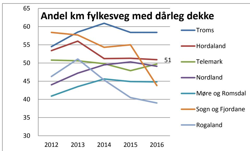
Over 50 % av fylkesvegane i Hordaland har dårlig/svært dårlig dekke, bare i Troms fylke er det høgare. Rogaland har no ein andel som er under 40 %, denne var på 50 % i 2013. Det har dei nådd ved at om lag 10 % av fylkesvegane har fått nytt dekke pr år i 2015 og 2016. For Hordaland var det 7 % i 2015 og 1 % i 2016,
