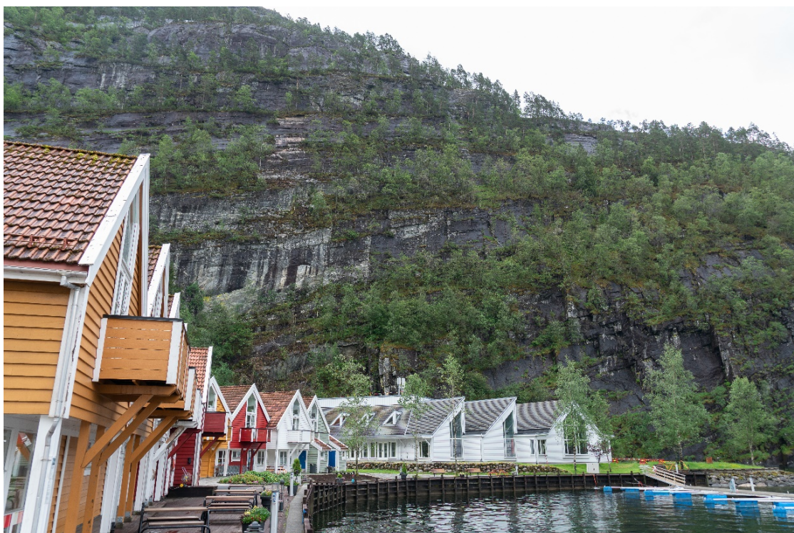
Figur 2-2: Oversiktsfoto fra brygga. Bryggjeslottet (hvitt) ses lengst mot høyre og løснеområder for steinsprang er synlige som lyse partier i fjellsiden.
