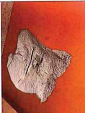
P5a og b er testing av betong fra grunnmur (den eldste delen av bygget). Verdien for krom VI overstiger normverdigrensen ( 2mg). Dersom betongen ønskes brukt, må det utføres risikovurdering ved bruksformålet og det må søkes godkjenning for bruk.
