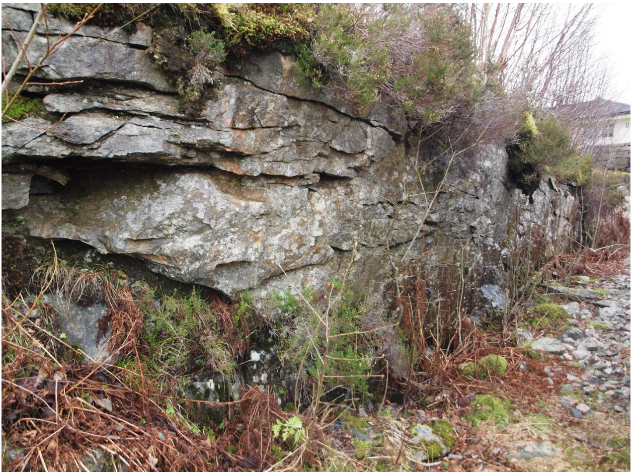
Figur 1-13. Overflaten på berggrunnen viser varierende retning på lag og sprekker.
