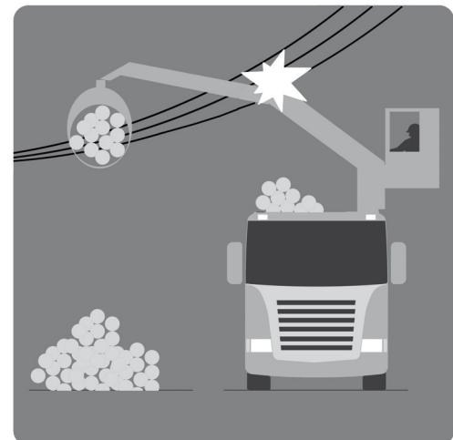
Bonden sto på førerhustaket på lastebilen for å styre på plass stålrammen. Arbeidsoperasjonen foregikk under en 22 kV høyspenningslinje tilhørende everket i området. Stålrammen hang i løftearmen på gravemaskinen og ble spenningsatt da løftearmen kom i berøring med høyspenningslinjen.
