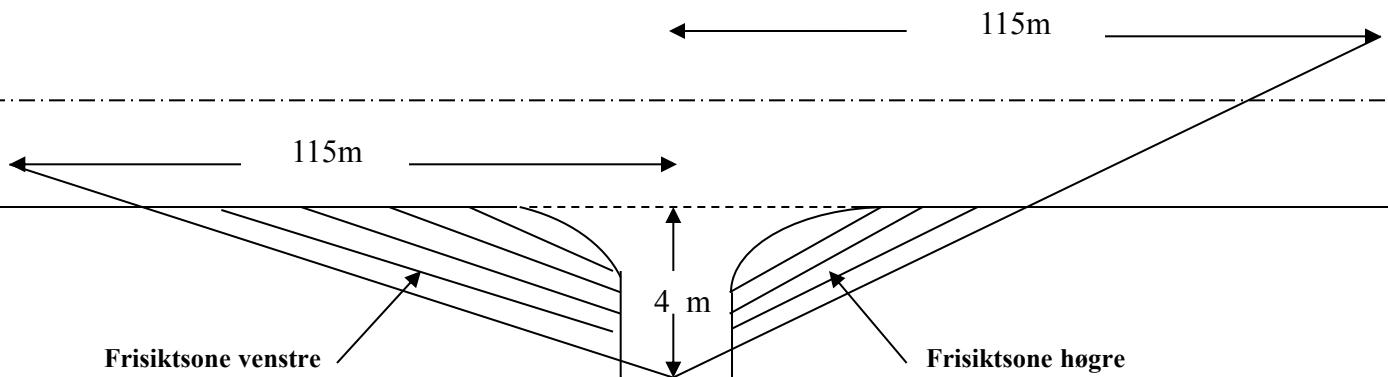
Tilsvarande sikt lengder som vist på tegningen må også gjera st gjeldande for trafikken som kjem på hovedvegen og skal inn i avkjørsla (sikt bakover og framover langs hovedvegen)
