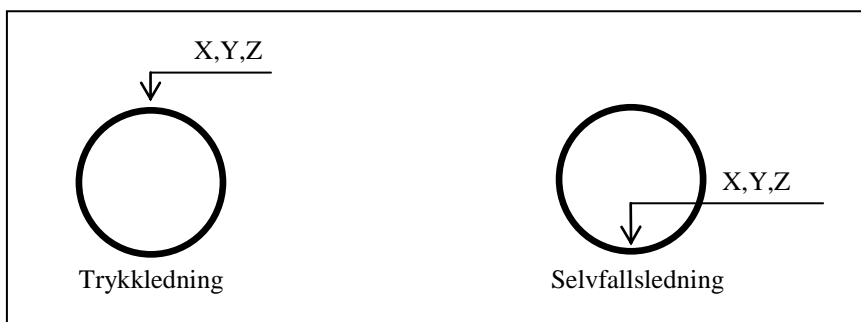
Figur 1. Måling av ledningshøyde.
