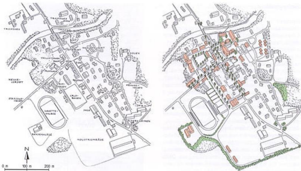
Fig. 33 b Tettstedsutvikling i Fåvang. Tegning viser eksisterende bebyggelse og muligheter for nybygg. Opprusting av gater og plasser, treplanting og nybygg ved fortetting på ledige tomter skal styrke sentrum i tettstedet funksjonelt og estetisk. Til venstre: Situasjon for fortetting, til høyre situasjon etter fortetting. Tegning: Schjetlein og Tønseth arkitektkontor
