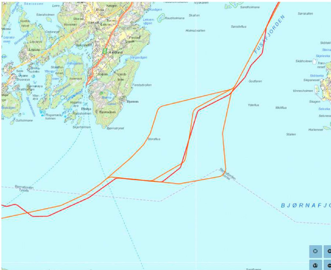
Figur 24 Delstrekning 6 med sjøkabel mellom Fusafjorden og Bjørnafjorden
