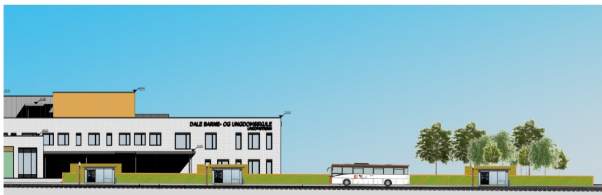
Prinsipp for utforming av støyskjerm med venteskur.
