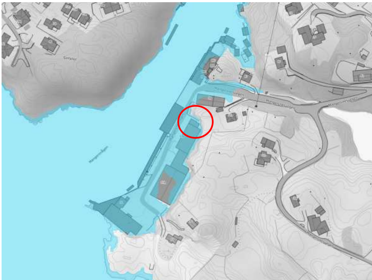
Figur 1. Utsnitt frå sehavnivå.no sitt kartverktøy for havnivå og stormflo. Utsnittet synar havnivå i 2090 med vasstansnivå tilsvarande 200-års stormflo. Raud sirkel synar området kvar nytt reinseanlegg er tenkt etablert.
