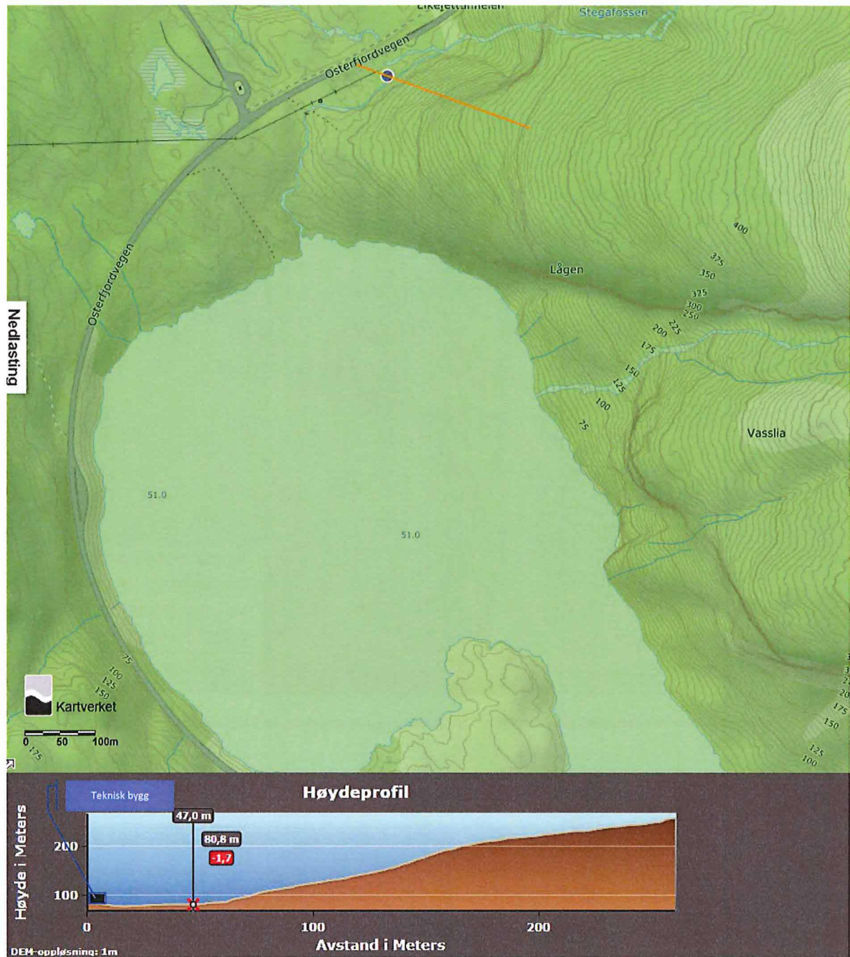
Figur 5: Høydeprofil og utsnitt av inntegnet profil i kart. Markøren i høydeprofilen viser bakkens beliggenhet, mens svart rektangel viser teknisk bygg. Av høydeprofilen kan man se at terrenget stiger jevnt østover fra ca. 60 m bak bygget.
