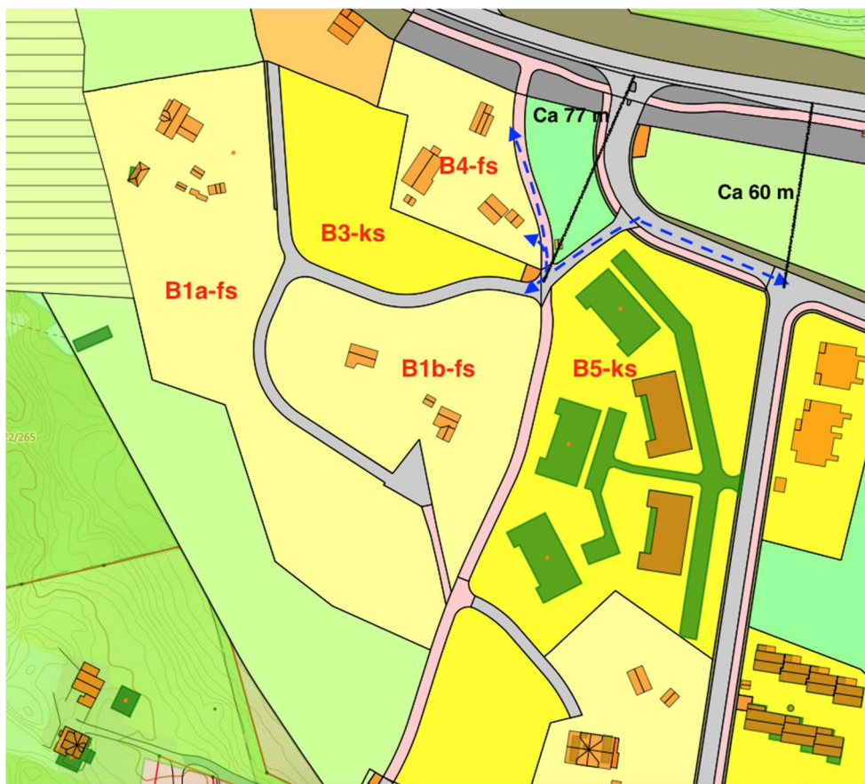
Figur 4: Utsnitt fra nordhordalandskart.no som viser gjeldende plan for Mjåtveitmarka med områder markert. Sorte linjer viser avstand fra hhv. avkjørselspunkt B1 og B3 til dagens kryss i fra fylkesveien (ca 77 meter), samt avstand fra fylkesvei til påkoblingspunkt for ny kryssløsning mot eksisterende vei (ca 60 meter). Blå stiplet linje viser mulig påkoblingspunkt mot ny vei, samt avkjørsel til B1 og B3, samt eksisterende boliger på B4-fs.
