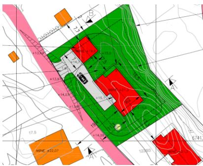
Svingradius i avkjørsla er ikkje målsett. Svingradius er i forskrift satt til å være minimum 4,0 meter.
