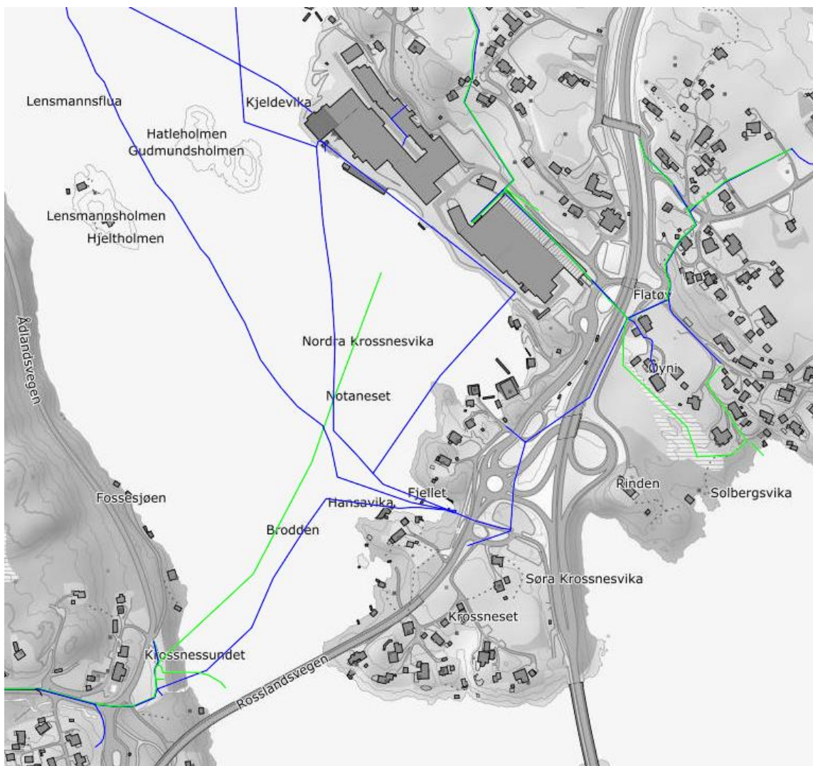
Figur 2 Forslag til trase for spillvassleidning i sjø (grøn) frå Frank Mohn Flatøy til Krossnessundet/Fosse
