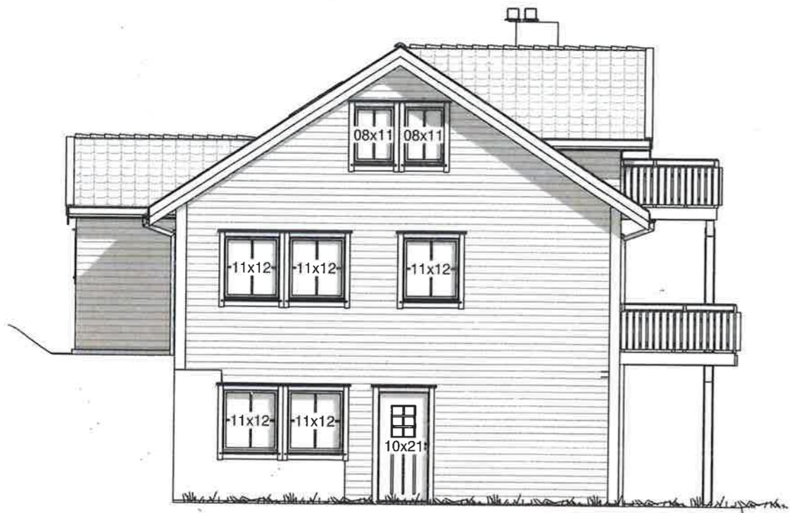
Arbeidstegning Fasade sør - øst 1 : 100
