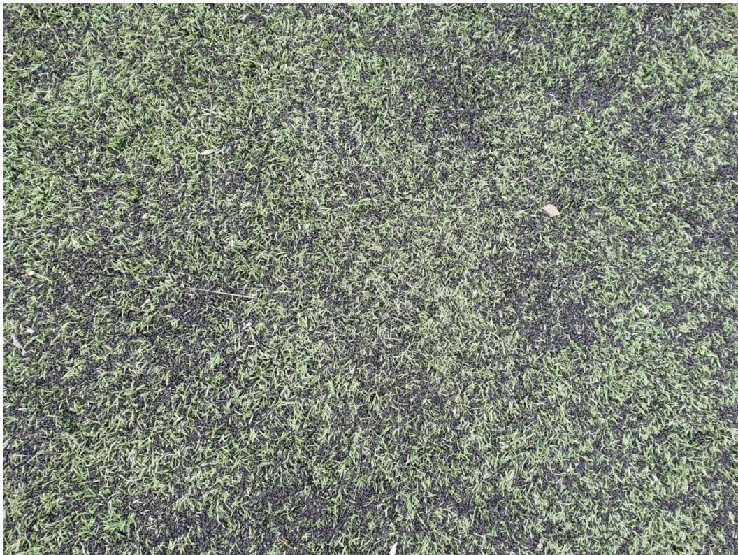
Fig.1 Tett sammenfiltret kunstgressmatte med deformerte fibre.
