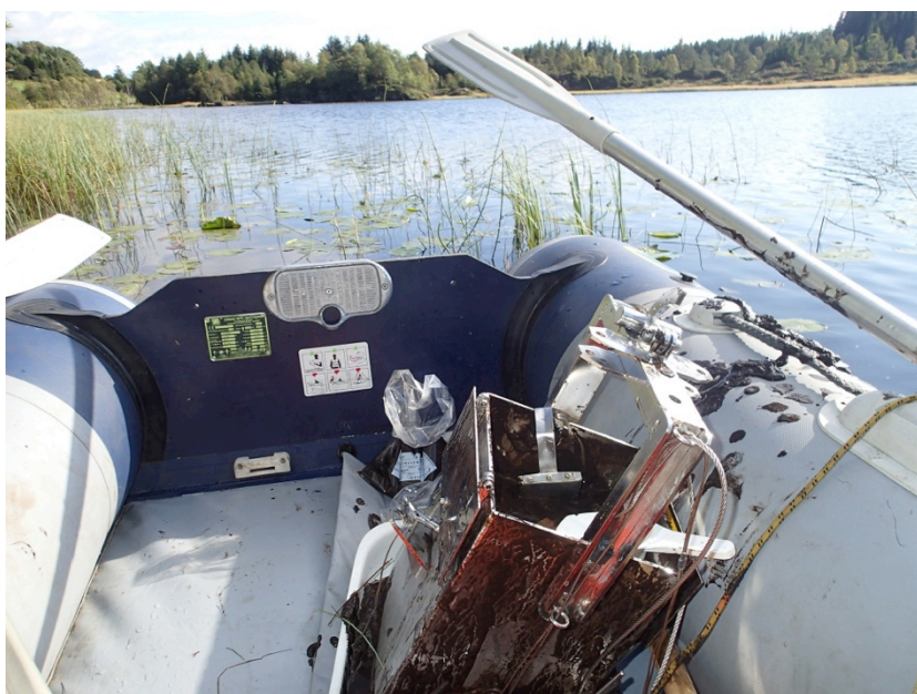
Figur 3. Prøvetaking med grabb (Ekman grab, 400 cm 2 ) etter miljøgift i Hopsvatnet. Prøvar frå grabben blei teken med bruk av skei av metall eller av plast, avhengig av kva for eit stoff som skulle analyserast. Foto: Uni Research (G. Velle).
