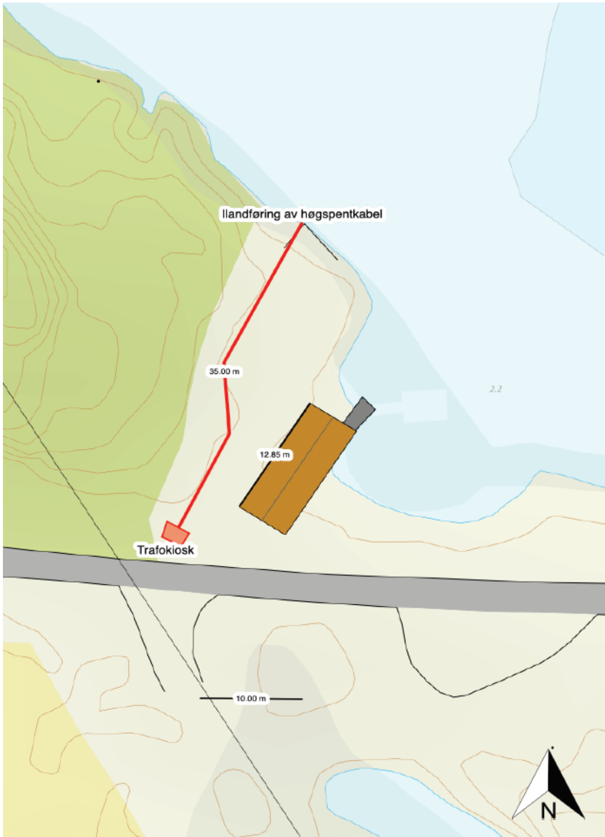
Figur 2: Ilandføring av kabelen til BKK Nett sin nettstasjon på Floni
