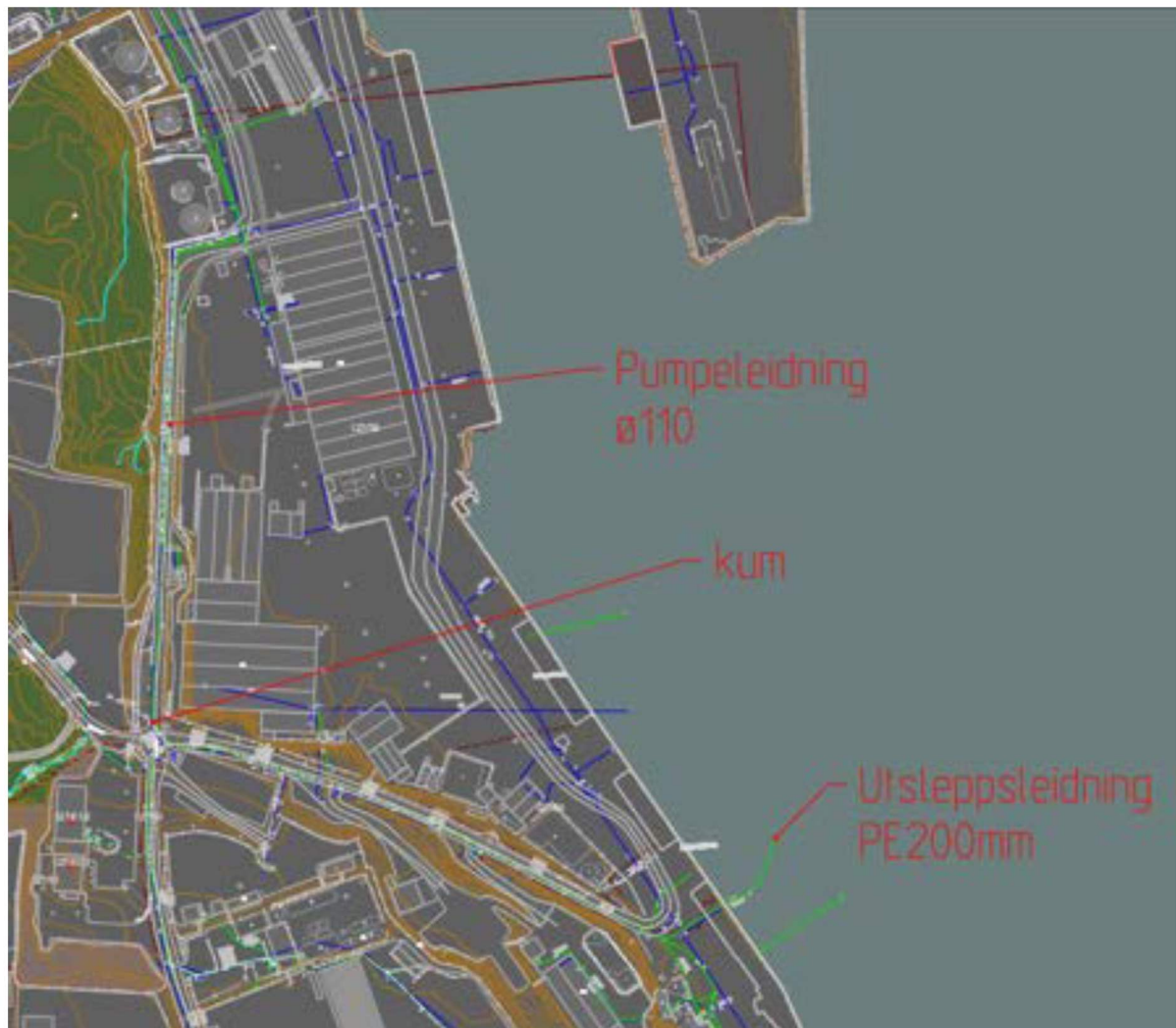
Figur 5: Pumpeledning og utsleppsledning
