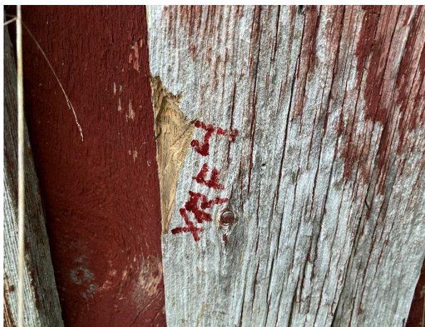
Figur 3: Eksempel på merking av XRF-målepunkt
