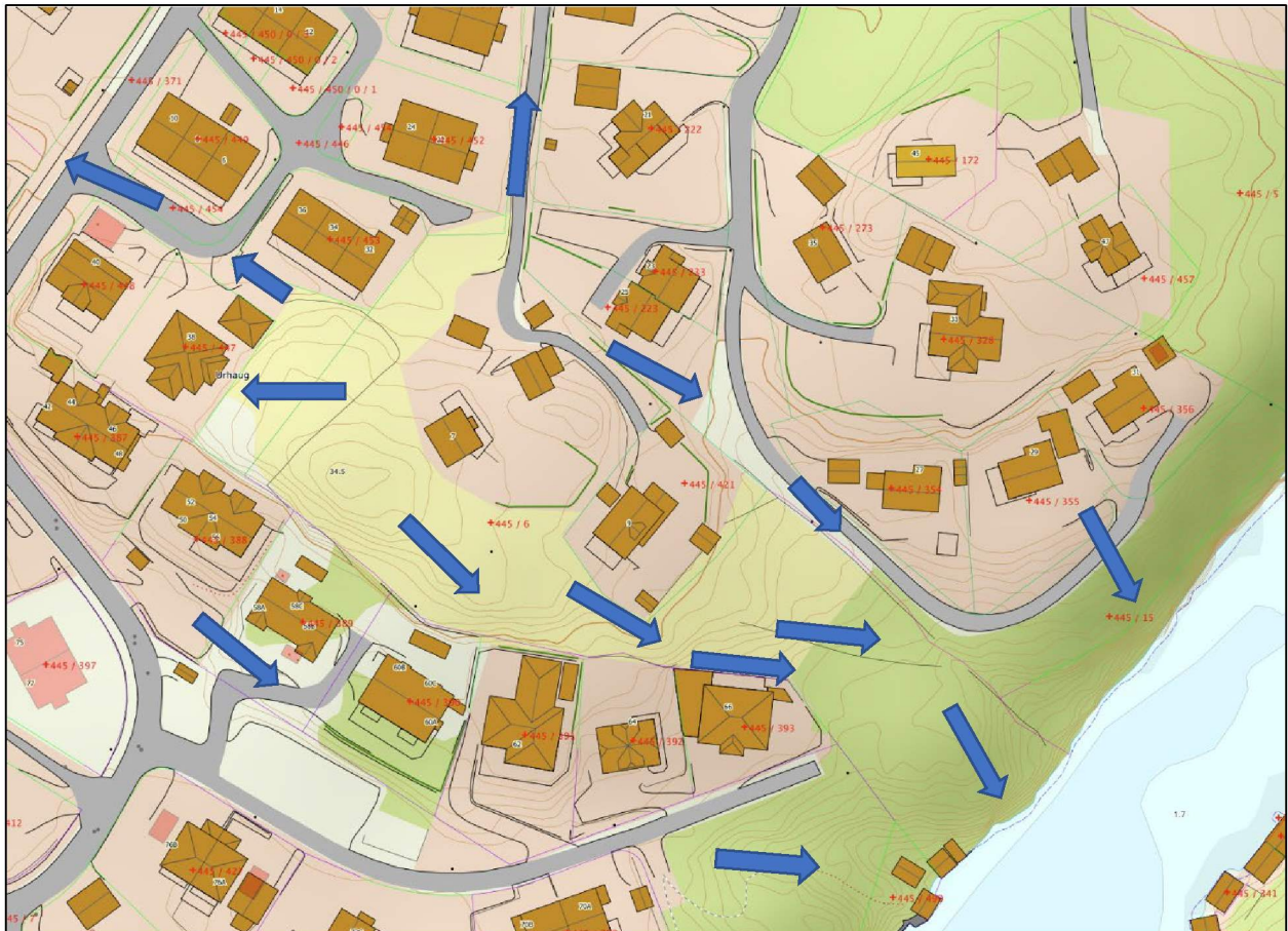
Figur 4. Lokalt nedbørsfelt og avrenning frå dette.
