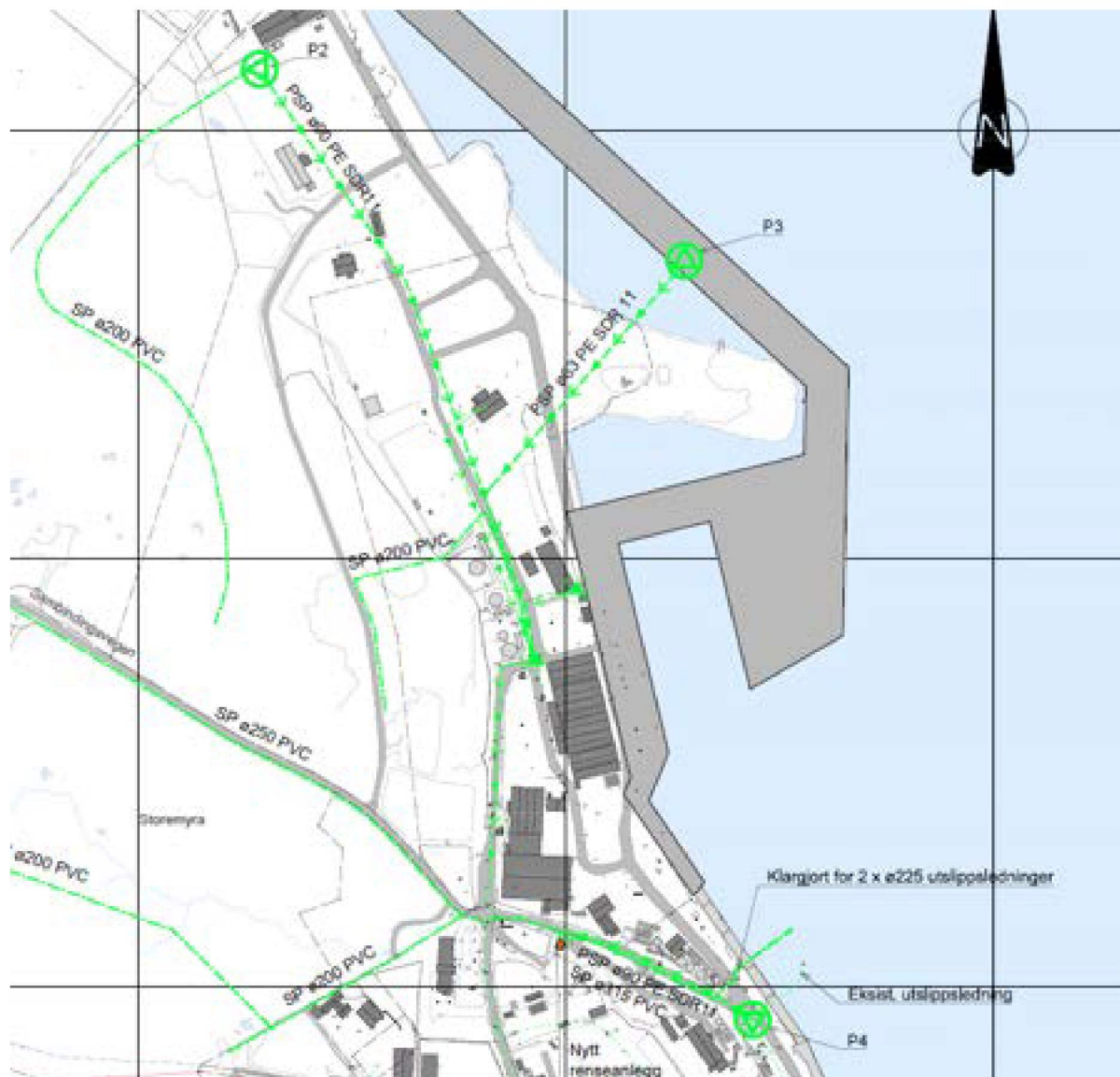
Figur 9: Planlagde spillvassleidninger. Utsnitt av VA masterplan (ref. rapport frå Norconsult)
