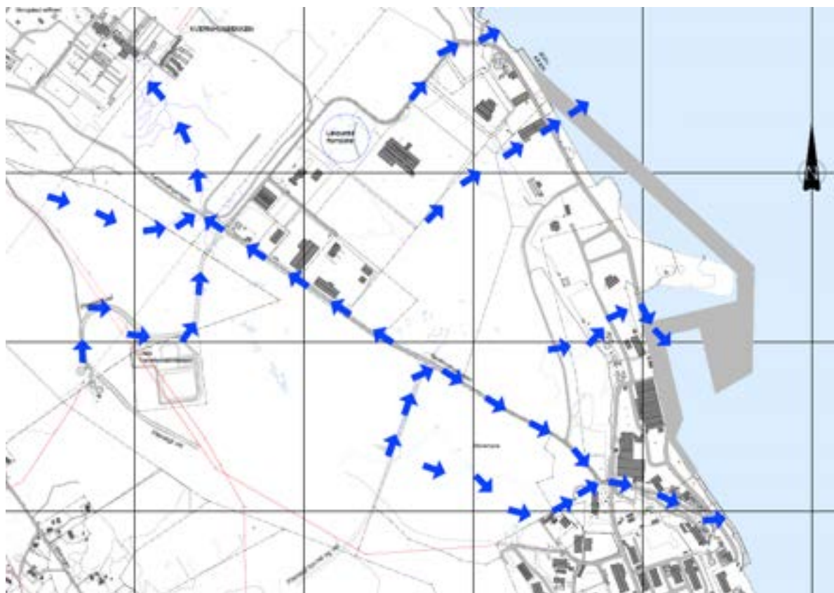
Figur 14: Planlagde flomvegar. Utsnitt av VA masterplan (ref. rapport frå Norconsult)
