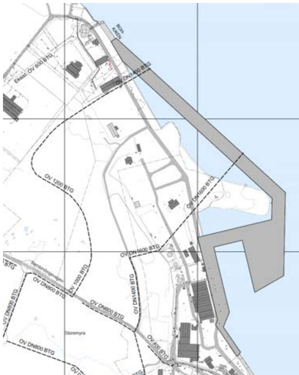
Figur 12: Planlagde overvassleidninger. Utsnitt av VA masterplan (ref. rapport frå Norconsult)
