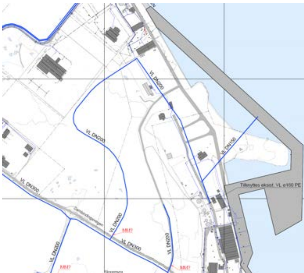
Figur 8: Planlagde vassleidninger. Utsnitt av VA masterplan (ref. rapport frå Norconsult)
