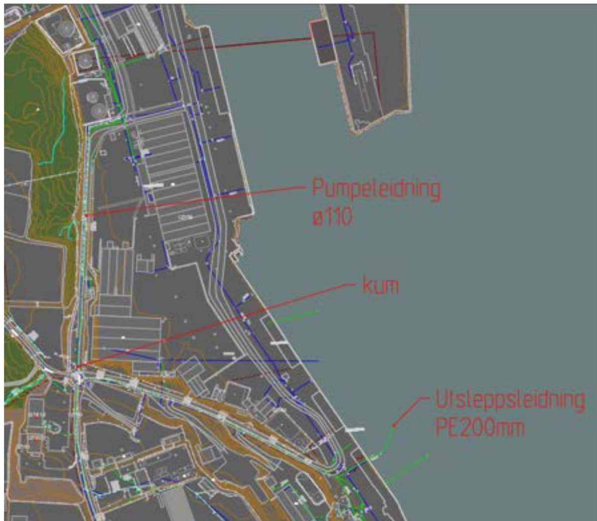
Figur 5: Pumpeledning og utsleppsledning
