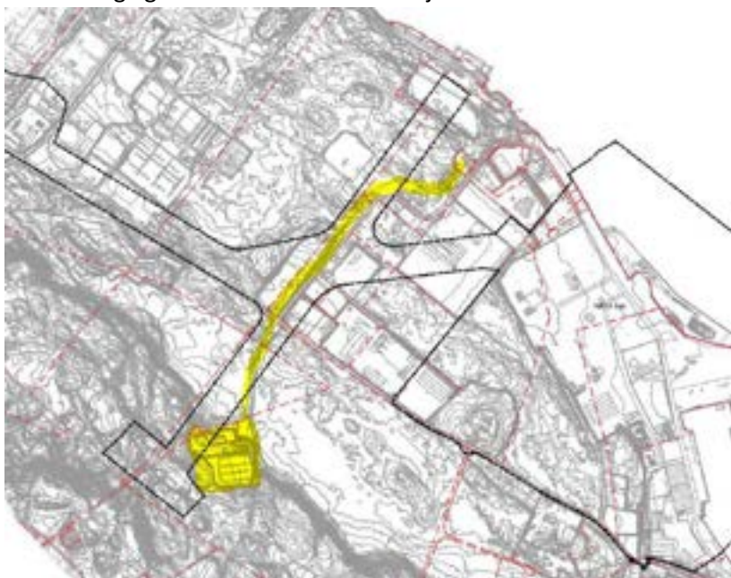
Figur 3-11 Lindås transformatorstasjon og luftleidninga mot muffeanlegget markert med gult. Kjelde: Statnett.
