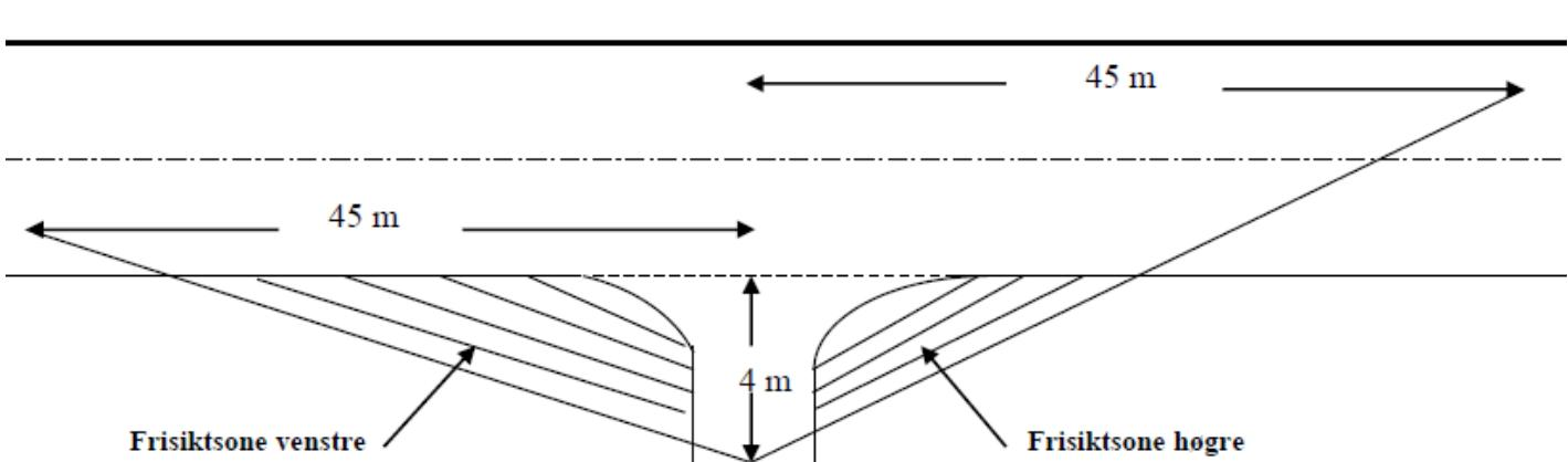
Tilsvarande sikt lengder som vist på tegningen må også gjeraast gjeldande for trafikken som kjem på hovedvegen og skal inn i avkjørsla (sikt bakover og framover langs hovedvegen)
