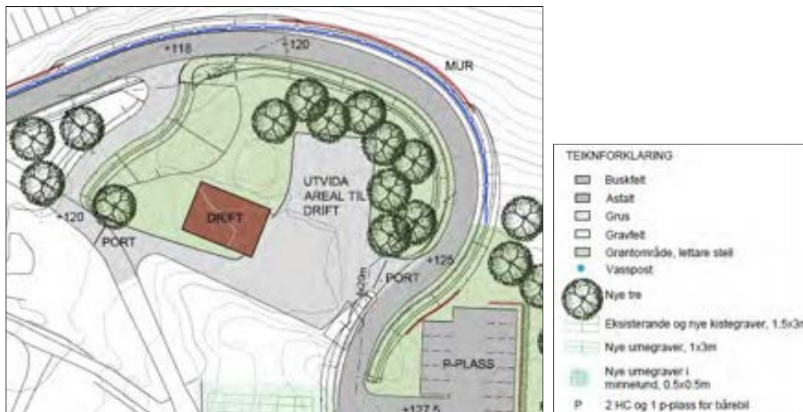
Figur 6-6 Utsnitt av illustrasjonsplan som viser driftsområde (o_BNG1) med tilhørende vegsystem og plassering av portar.
