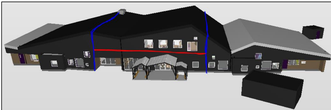
Figur 2: Oppdeling i brannceller EI 60 vertikalt for hver avdeling vist med blå streker, personaldel EI 30 med rød strek.
