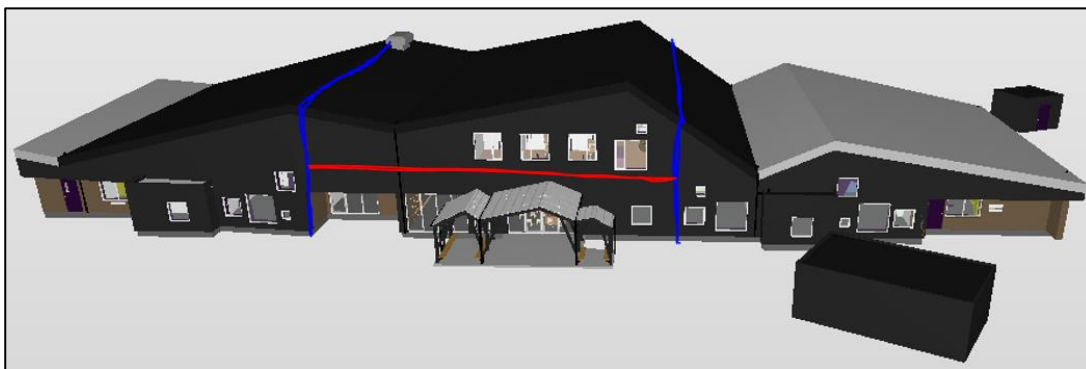
Figur 4: Oppdeling i brannceller EI 60 vertikalt for hver avdeling vist med blå streker, personaldel EI 30 med rød strek.
