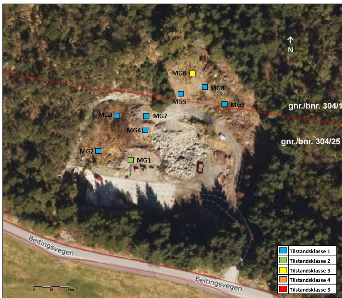
Figur 5: Oversiktskart over tilførte masser prøvetatt av Norconsult i mars 2021 ved Meland golfbane. Punktene er fargekodet iht. tilstandsklasse gitt i veileder TA-2553. Figuren tar ikke hensyn til prøveparameter eller dybde, men angir høyeste påviste tilstandsklasse for hvert prøvepunkt ( se vedlegg 2).
