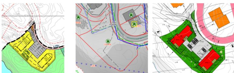
I søknad må minste avstand mellom mur og nærmeste del av kommunalt leidningsnett være oppgitt. Med søknad skal det leggast ved eit VA-kart der mur er inntekna. Avstander skal være målsett. Det skal også leggast ved tværsnitt gjennom mur som viser muren sin plassering i forhold til kommunalt leidningsnett.
