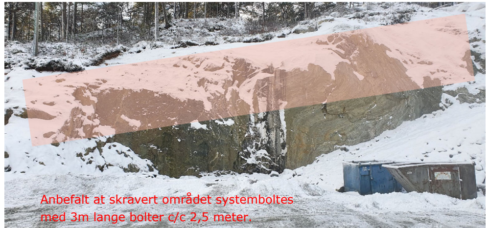
Figur 14 Anbefalt område med systembolting bak nybygg.
