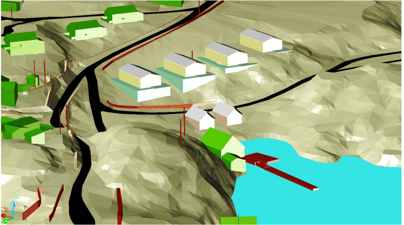
Byggjetomta må fyllast opp i nedre delen, her illustrert med eit fundamentvolum (lys grøn farge) lagt 2 meter utafor bygget på alle sider. Oppfyllinga vert 3 -4 meter i framkant av hus 3 og 4.
