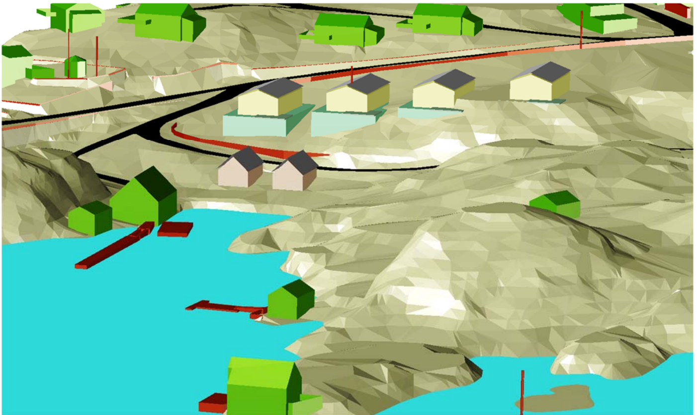
Byggjetomta må fyllast opp i nedre delen, her illustrert med eit fundamentvolum (lys grøn farge) lagt 2 meter utafor bygget på alle sider. Oppfyllinga vert 3 -4 meter i framkant av hus 3 og 4.
