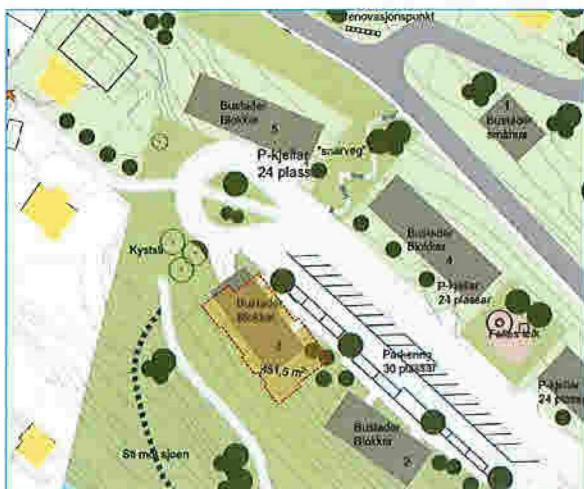
Varslet bygg inntegnet på 3d kart fra Norkart. Høyde og plassering ut fra oversendt materiale i nabovarsel. Som modellen viser er det ikke helt etterrettelig å kalle parkeringsetasjen for en kjeller, da det må til massive terrengbearbeidelser for å heve terrenget i front så den kommer under bakkenivå.
